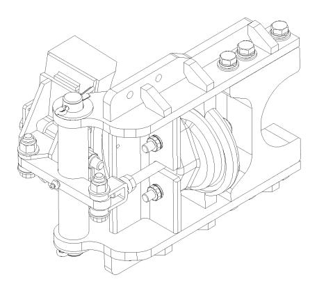
INSTALLATION OF FRONT AIR BRAKE KIT
